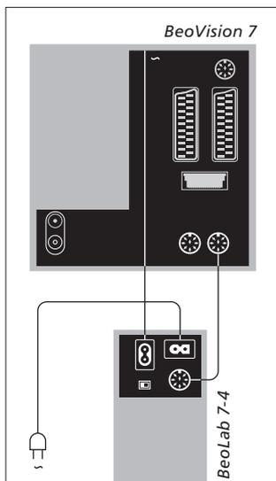
Los dos cables de alimentación y el cable Power Link se adjuntan con BeoVision 7.
