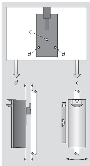
**Ajustes:** Utilice los dos tornillos (d) para alinear el altavoz con el soporte de pie o de pared. Después, coloque el altavoz de modo que la cara quede vertical, y, por último, apriete el tornillo (c).
