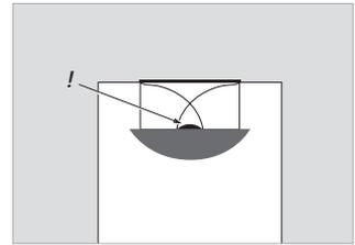
**Precaución:** ¡No toque la membrana del altavoz al descubierto en la lente acústica!
