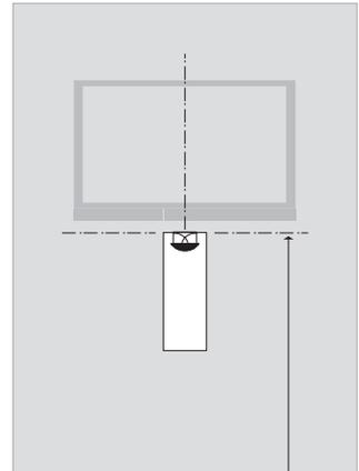
**Ubicación:** El altavoz debe colocarse centrado debajo de la pantalla. Coloque siempre el altavoz en posición vertical.
